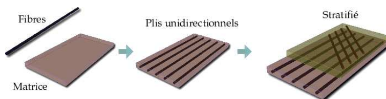
Figure 5.1 – Constitution du composite stratifié à fibres longues
